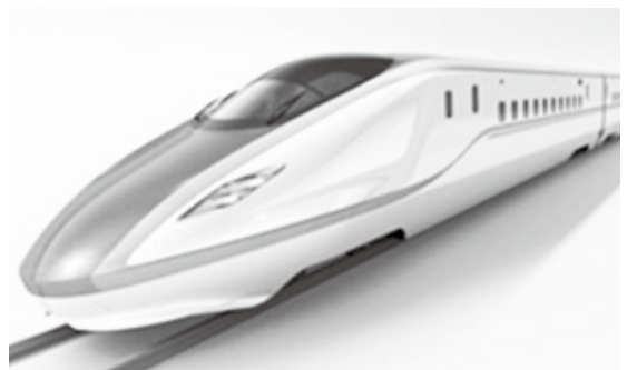
東京・金沢間の運行を予定している車両です。 E7系(JR東日本)、W7系(JR西日本)、編成12両、定員934名 (現在、北陸新幹線の名称も募集中です)
